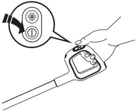
Drücken Sie die Taste ①, um das Gerät standardmäßig im AUTO-Modus zu starten. Drücken Sie die Taste erneut, um das Gerät auszuschalten. Wechseln Sie durch Drücken der -Taste zwischen AUTO- und MAX-Modus.
