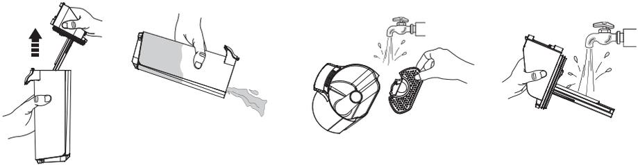
Wenn der Deckel des Schmutzwasserbehälters und der Filter im Inneren verstopft sind, entfernen Sie Behälterdeckel und Filter und spülen Sie beide Teile mit Wasser ab.
