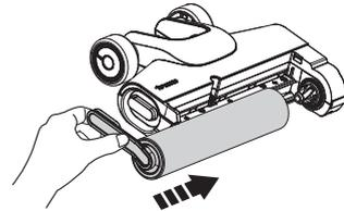
Setzen Sie die Bürstenrolle wieder ein, indem Sie das Bürstenrollenende in die rechte Seite der Halterung einsetzen und dann die Lasche der Rolle an der magnetischen Schließe auf der linken Seite befestigen, um sie zu verriegeln.
