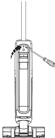
Falls das Produkt zurückgegeben werden muss, nehmen Sie den Griff ab. Drücken Sie die Feder mit einem Werkzeug (wie einem Schraubendreher), um den Griff zu lösen, und nehmen Sie den entriegelten Griff vom Gerät ab.
