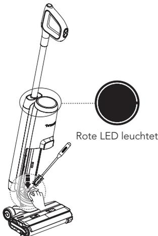
Wenn der LED-Ring rot leuchtet, entfernen Sie den Schmutzwasserbehälter und reinigen Sie den Schmutzsensord mit einem feuchten Tuch oder dem Reinigungswerkzeug.
