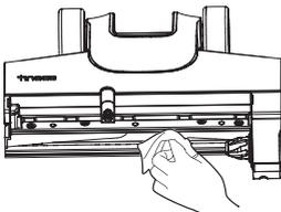
Entfernen Sie Haare und Schmutz mit einem Papiertuch oder einem feuchten Tuch aus der Bürstenrollenkammer und der Öffnung.
