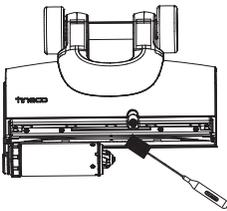
Entfernen Sie mit dem Reinigungswerkzeug Haare und Verunreinigungen aus der Kammer der Bürstenrolle und der Öffnung.
