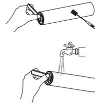
Verwenden Sie das Reinigungswerkzeug, um Haare und Verschmutzungen zu entfernen, die sich um die Bürstenrolle gewickelt haben, und spülen Sie sie mit Wasser ab. Setzen Sie die Bürstenrolle wieder in den Zubehöralter ein, und lassen Sie sie vollständig trocknen, bevor Sie sie wieder in das Gerät einsetzen.
