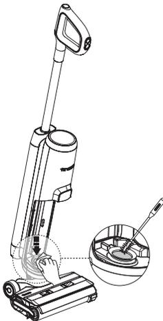
Reinigen Sie den Schmutzsensoren mit einem feuchten Tuch oder dem Reinigungswerkzeug.
