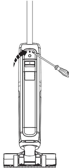
Falls der Griff gelöst werden muss, drücken Sie die Feder mit einem Werkzeug (z. B. einem Schraubendreher) und nehmen Sie den gelösten Griff vom Gerät ab.
