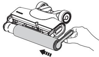
Setzen Sie die Bürstenrolle wieder ein, indem Sie ihr Ende in die linke Seite des Halters einführen und dann die Nase der Bürstenrolle am Magnetverschluss auf der rechten Seite befestigen, um sie einzurasten.
