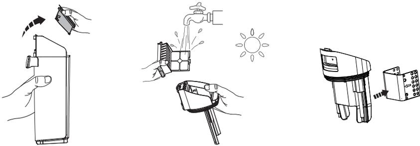
Fassen Sie den vertieften Bereich auf jeder Seite des Trockenfilters und ziehen Sie ihn nach oben. Spülen Sie ihn unter fließendem Wasser ab. Der Filter muss vollständig trocken sein, bevor Sie ihn wieder in den Deckel des SWB einsetzen.
