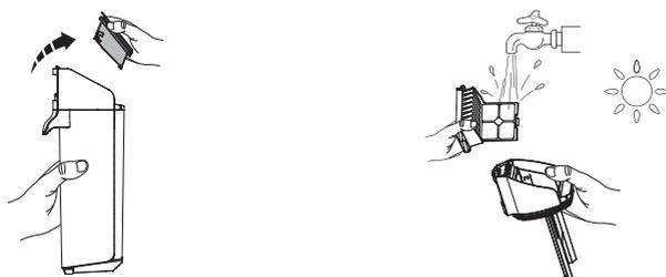
Saisissez les zones en creux de chaque côté du filtre sec et tirez vers le haut. Rincez sous l'eau courante et laissez sécher complètement avant de replacer le filtre HEPA dans le couvercle du RES.
