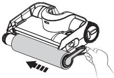
Setzen Sie die Bürstenrolle wieder ein, indem Sie ihr Ende in die linke Seite des Halters einführen und dann die Nase der Bürstenrolle am Magnetverschluss auf der rechten Seite befestigen, um sie einzurasten.
