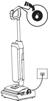
1. Stellen Sie das Gerät nach Gebrauch auf die Lade-Dockingstation. Der Sensor erkennt automatisch den Verschmutzungsgrad.
