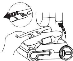
Drücken Sie die Entriegelungstaste für den Friskwasserbehälter, um ihn vom Gerät zu entfernen.
