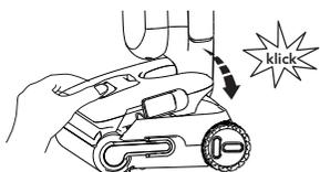
Setzen Sie den Behälter wieder in das Gerät ein. Wenn Sie den Vorgang korrekt ausgeführt haben, sollten Sie ein „klick“ hören.
