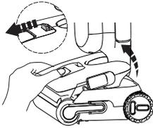
Drücken Sie die Entriegelungstaste für den Frischwasserbehälter, um ihn vom Gerät zu entfernen.
