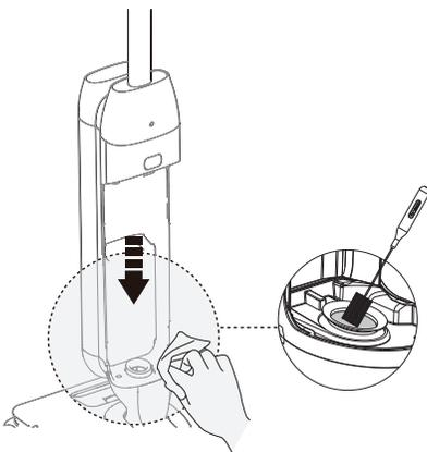
Reinigen Sie den Schmutzsensor mit einem feuchten Tuch oder dem Reinigungswerkzeug.
