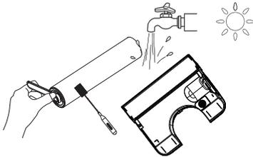
Verwenden Sie das Reinigungswerkzeug, um Haare und Verschmutzungen zu entfernen, die sich um die Bürstenrolle gewickelt haben, und spülen Sie die Rolle und die Rückseite des CWT mit Wasser ab. Lassen Sie sie vor dem erneuten Einsetzen vollständig trocknen.
