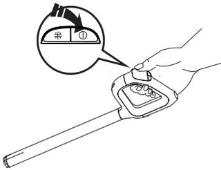
Schalten Sie das Gerät vor den Wartungsarbeiten aus, um das Verletzungsrisiko zu verringern.
