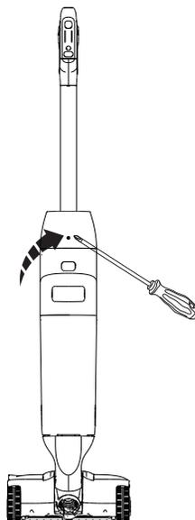
Falls der Griff gelöst werden muss, drücken Sie die Feder mit einem Werkzeug (z. B. einem Schraubendreher) und nehmen Sie den gelösten Griff vom Gerät ab.
