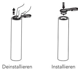
Ziehen Sie den Griff der Rolle zum Herausnehmen nach oben. Setzen Sie den abgenommenen Griff in die neue Bürstenrolle ein.
