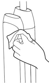
Verwenden Sie ein Tuch, um die Oberfläche mit einem neutralen Reinigungsmittel zu reinigen. Das Tuch sollte trocken sein, damit kein Wasser in das Gerät eindringen kann.
