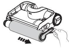
Greifen Sie die Bürstenrollenlasche und entfernen Sie die Bürstenrolle, indem Sie sie herausziehen.
