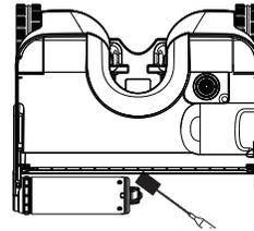
Entfernen Sie mit dem Reinigungswerkzeug Haare und Verunreinigungen aus der Kammer der Bürstenrolle und der Öffnung.
