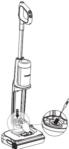
Reinigen Sie den Schmutzsensor mit einem feuchten Tuch oder dem Reinigungswerkzeug.
