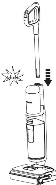
Um den Griff zusammenzusetzen, setzen Sie ihn in das Gerät ein, bis er hörbar einrastet.
