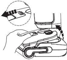
Drücken Sie die Entriegelungstaste für den Friskwasserbehälter, um ihn vom Gerät zu entfernen.
