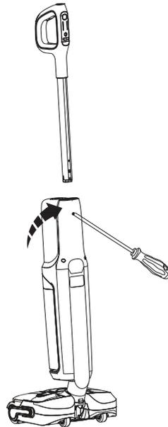
Falls der Griff gelöst werden muss, drücken Sie die Feder mit einem Werkzeug (z. B. einem Schraubendreher) und nehmen Sie den gelösten Griff vom Gerät ab.
