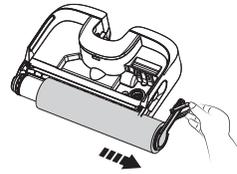
Greifen Sie die Bürstenrollenlasche und entfernen Sie die Bürstenrolle, indem Sie sie herausziehen.
