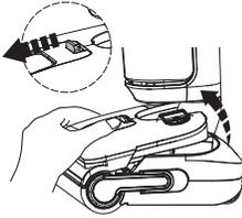
Drücken Sie die Entriegelungstaste für den Frischwasserbehälter, um ihn vom Gerät zu entfernen.
