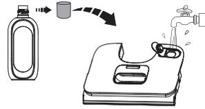
Öffnen Sie den Behälter und füllen Sie mit Leitungswasser. Wenn eine gründliche Reinigung erforderlich ist, fügen Sie dem FWB einen Flaschenverschluss der Lösung hinzu, und schließen Sie den Verschluss fest.
