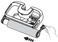
Setzen Sie die Bürstenrolle wieder ein, indem Sie ihr Ende in die linke Seite des Halters einführen und dann die Nase der Bürstenrolle am Magnetverschluss auf der rechten Seite befestigen, um sie einzurasten.
