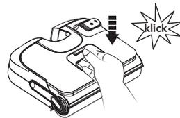
Setzen Sie den Behälter wieder in das Gerät ein. Wenn Sie den Vorgang korrekt ausgeführt haben, sollten Sie ein „klick“ hören.
