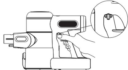
Betätigen Sie die Verriegelung des Einschalthebels und halten Sie den Einschalthebel für den Dauerbetrieb gedrückt.
