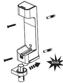
Setzen Sie beide Komponenten der Halterung mit einem „Klick“ zusammen, was den korrekten Zusammenbau bestätigt. Sobald dies abgeschlossen ist, befestigen Sie die Dockingstation mit den von Tineco mitgelieferten Schrauben an der Wand.
