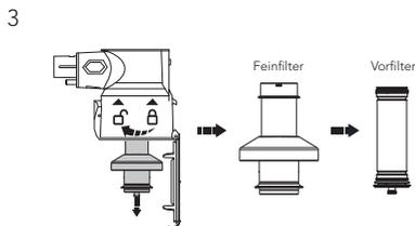
Drehen Sie gegen den Uhrzeigersinn, um die Filter zu entfernen.
