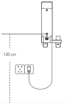
Legen Sie die beste Stelle für die Montage der Dockingstation an der Wand fest. Wir empfehlen, sie in einer Höhe von 120 cm (vom unteren Schraubenloch bis zum Boden gemessen) zu montieren (möglicherweise muss die Höhe je nach tatsächlicher Situation angepasst werden).
