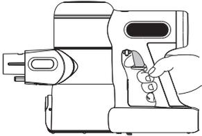
Betätigen Sie den Einschalter, um den Staubsauger zu starten.
