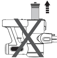
Drehen Sie das Gerät beim Aus- und Einbau des Filters nicht auf den Kopf, um das Eindringen von Staub in den Motor zu verhindern.
