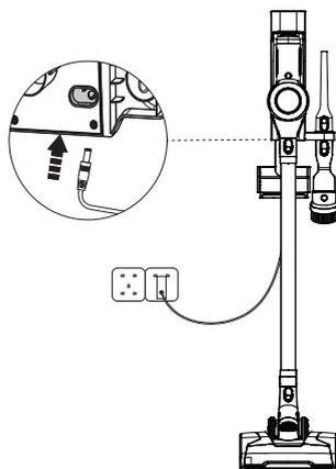
Setzen Sie das Gerät auf die Dockingstation und schließen Sie das Ladegerät an eine Steckdose und die Ladebuchse an. Die blaue LED am Gerät blinkt und zeigt damit den ordnungsgemäßen Ladevorgang an.
