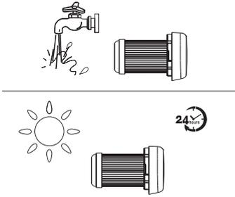
Der HEPA-Filter kann bei Bedarf unter fließendem Wasser gereinigt werden. Er muss vor dem Einsetzen vollständig trocken sein.
