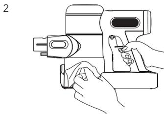
Reinigen Sie ihn mit einem feuchten Tuch. Achten Sie dabei darauf, dass kein Wasser in das Gehäuse des Hauptgeräts und den Akku eindringt.
