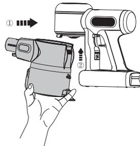
Halten Sie den Staubbehälter zum erneuten Anbringen schräg und stecken Sie seine Oberseite in den Haken am Hauptgerät. Drücken Sie den Staubbehälter nach oben, bis der Haken im Schlitz des Staubbehälters einhakt. Er rastet dann ein.
