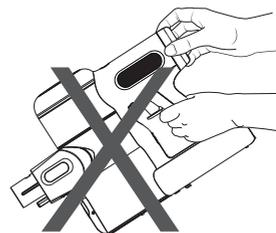
Halten Sie das Gerät beim Aus- und Einbau des HEPA-Filters nicht wie oben dargestellt, um das Eindringen von Staub in den Motor zu verhindern.
