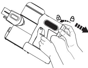
Drehen Sie den HEPA-Filter nach links und ziehen Sie ihn vorsichtig zur Reinigung heraus. Nehmen Sie das Gerät nicht ohne zuvor eingesetzten HEPA-Filter in Betrieb.
