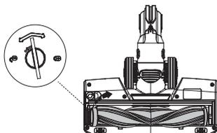
Mit einer Münze oder einem anderen Gegenstand die Bürstenrolle entriegeln und die Bürste aus der Bürstenöffnung entnehmen.
