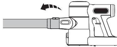
Drücken Sie die Freigabetaste, um das Rohr zu entfernen.
