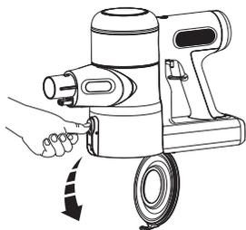
Drücken Sie die Entriegelungstaste seitlich am Staubbehälter, um ihn auszuleeren.
