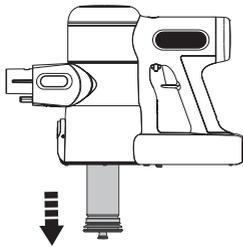
Vergewissern Sie sich, dass das Gerät vor der Reinigung ausgeschaltet wurde und entfernen Sie den verschmutzten Vorfilter aus der Feinfilterhalterung.
