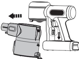
Um den Staubbehälter gründlicher zu reinigen, drücken Sie seine Freigabetaste, um ihn vom Gerät zu lösen.
