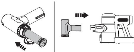
Einen sauberen Filter in das Gerät einsetzen. Den verschmutzten Vorfilter in das Reinigungsgerät schieben und das Reinigungsgerät an das Gerät anschließen.
